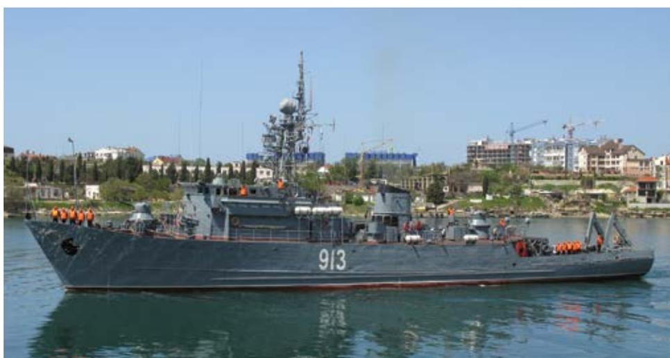
Корабли ПМО проекта 12700 имеют самый большой в мире корпус из стеклопластика. Преимуществом этого корпуса является более высокая прочность в сравнении со стальными корпусами, что обеспечивает большую живучесть корабля при поиске мин. Срок службы корпуса из монолитного стеклопластика больше, чем у корпуса из маломагнитной стали. При этом масса корпуса значительно меньше.
